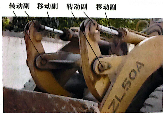
图2.7 装载机铲斗上的实际低副
